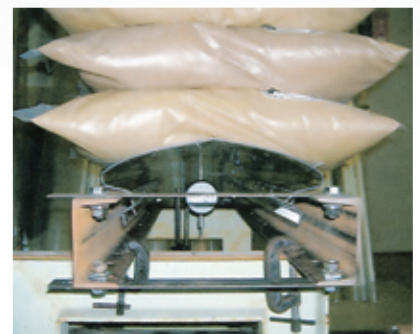
15 [kgf] × 3列 × 4段 = 180 [kgf] 積載状態 断面方向から撮影
